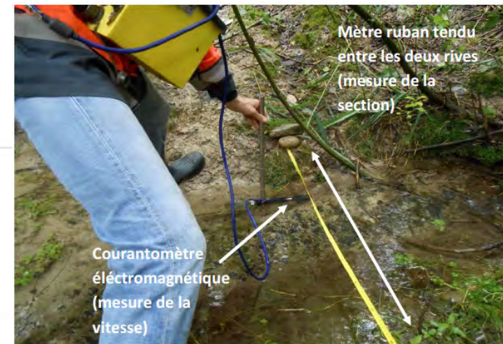
Figure 2-2 : Exemple de jaugeage sur la source n°1
